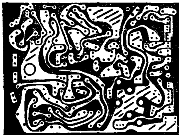
Рис. 6-31. Печатная схема, полученная травлением фольгированного гетинакса
